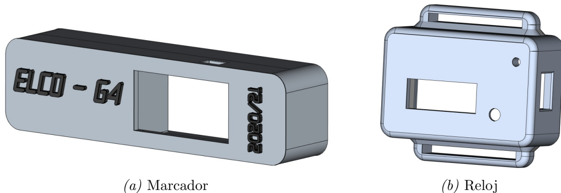
Figura 7: Modelo 3d de las carcasas
