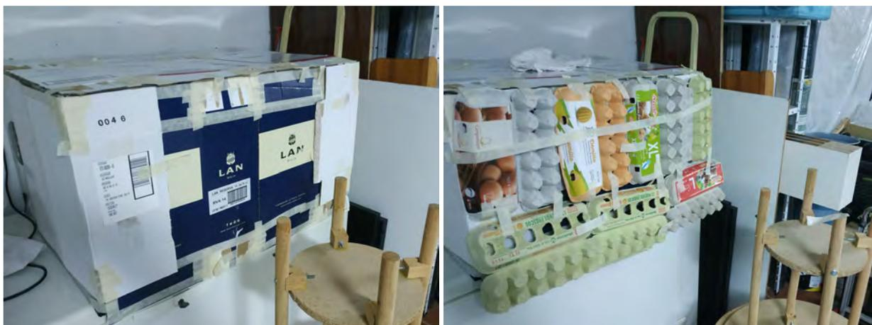
Figure 12: Montaje para los experimentos del análisis acústico: cartón y 10cm de distancia (izquierda) y cartón y cajas de huevos y 30cm de distancia (derecha)
