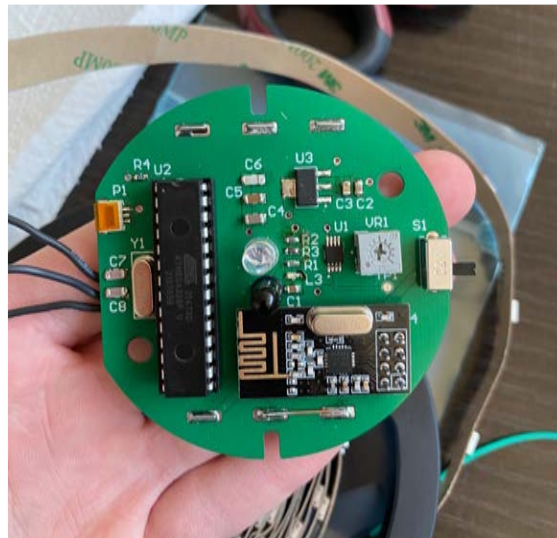
PCB del producto final montada con todos los componentes
