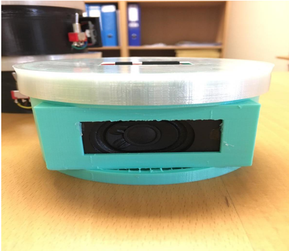
Abertura en la parte lateral para la reproducción de sonidos con el altavoz.
