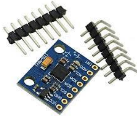
Figura 3. Acelerómetro y giroscopio GY-521 MPU-6050.
