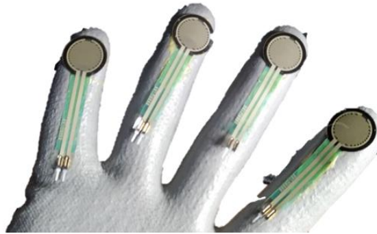
Figura 6. Sensores de presión pegados en las yemas.
