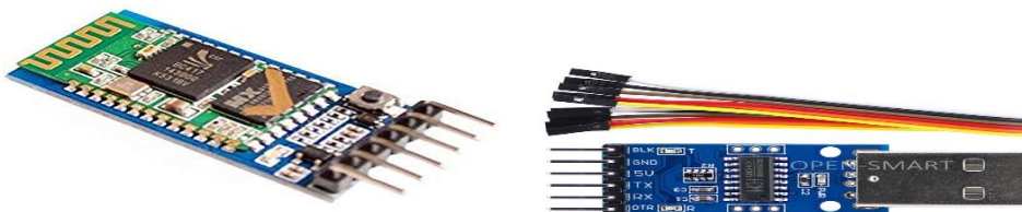
Figura 4. Módulos puerto serie USB (izquierda) y Bluetooth (derecha).
