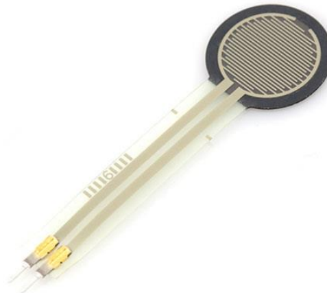
Figura 2. Sensor de fuerza resistivo circular (FSR).
