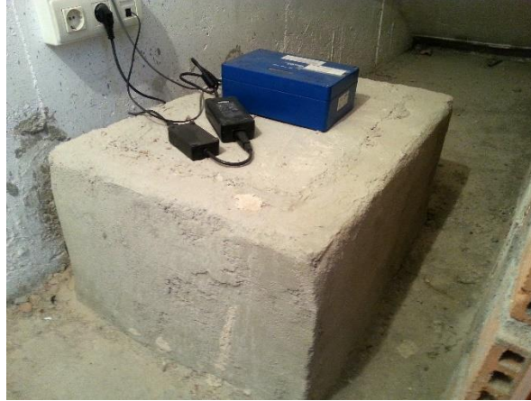
Figura 6: Acelerógrafo instalado en Arenas del Rey (GR).
