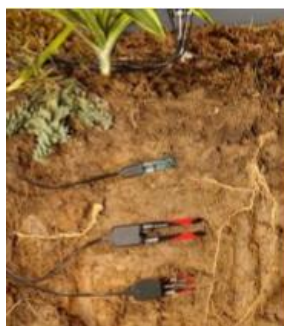
Figura 5 Disposición de los sensores en el suelo. Fuente Lab Ferrer.
