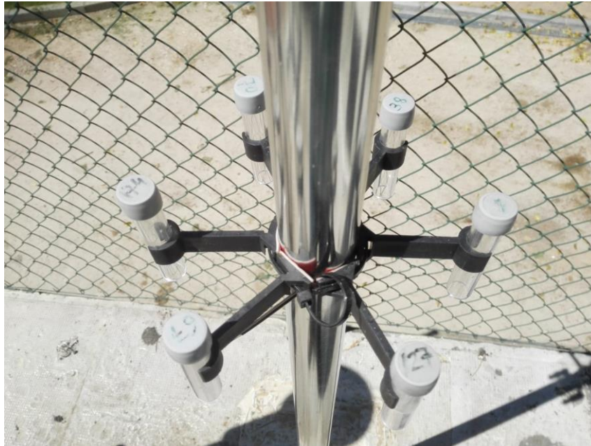
Figura 4. Tubos pasivos de difusión fijados correctamente.
