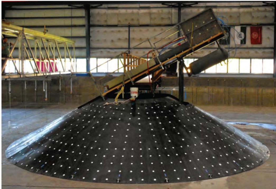
Figura 15. Generador de deslizamientos colocado sobre la isla cónica (Hubers et al., 2011).
