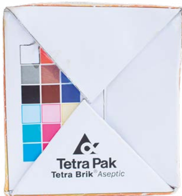
Figura 3: Marca de impresión empleada para verificar la calidad de la reproducción del color en los envases.
