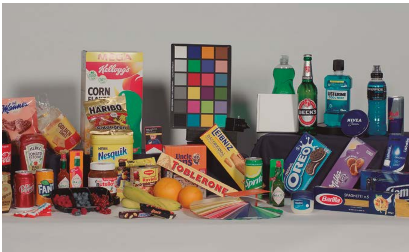
Figura 5: Paleta de colores ColorCheker empleada para corregir desviaciones en la reproducción del color.
