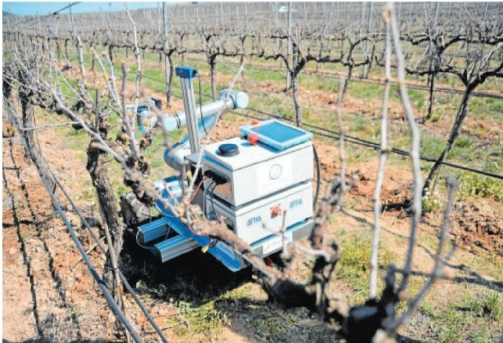
Brazos inteligentes para el viñedo Sobre estas líneas, tractor autónomo para la poda de viñedos desarrollado en el marco del proyecto Robotrim financiado por Codorniu y Femac
