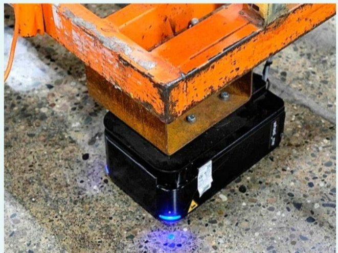
Ruedas autónomas que usa Stellantis para mover sus plataformas de producción.
