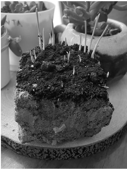
Fig. 3 Muestra de hormigón con sustrato universal, posos de café y semillas, Sofía Hortelano Márquez, Febrero 2024.
