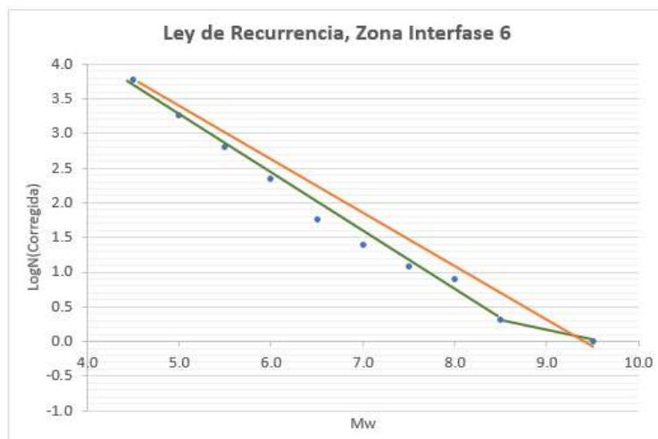
Figura 22. Comparación entre leyes de recurrencia. En anaranjado se observa a línea de tendencia obtenida automáticamente y en verde aquella obtenida luego de una comprobación manual.
