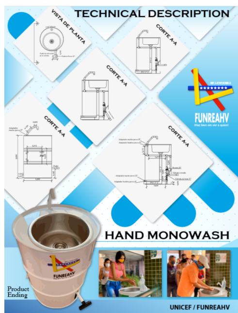
Estación desmontable con conexión a punto de agua en Venezuela, UNICEF – Funreahv, con apertura de grifo con pedal y tanque de agua.
