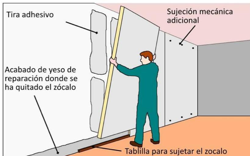
Fig. 12. Trasdosado interior: detalle de colocación de placas (ETRES Consultores, 2011).
