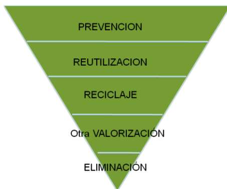
Figura 2. Esquema de la jerarquía de residuos de acuerdo al artículo 4 de la Directiva 2008/98/EC.
