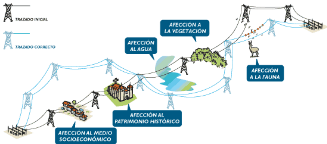
Figura III.6: Corrección de trazado de línea de transporte eléctrico tras EIA Fuente: REE
