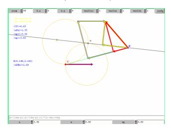
Aceleración para w´=0. En este caso la circunferencia estacionaria degenera en una recta que contiene a la aceleración del CIR. Este applet es una simplificación del primero que permite comprobar que todas las aceleraciones de los puntos pasan por H.
