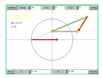
**Euler-Savary.** Moviendo el control por una recta que pasa por el CIR, determina gráficamente, aplicando la formula de Euler-Savary, el centro de curvatura de la trayectoria del punto en cada posición.
