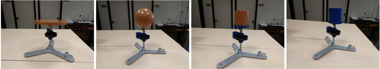
El montaje se realiza según las fotografías adjuntas. Para medir los m.d.i. de los diversos cuerpos, se fija el cuerpo a medir por su centro de gravedad al eje de rotación.
