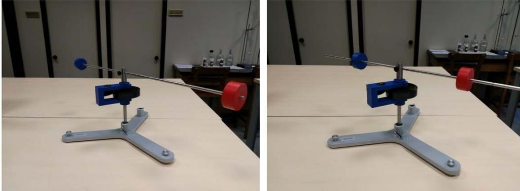
Tal y como se observa en la imagen, se monta en el eje de giro la varilla con las dos masas móviles fijándolas simétricamente.
