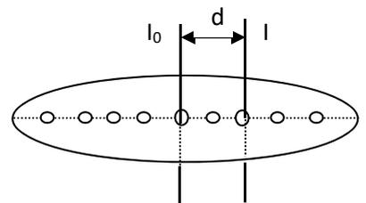
Por lo tanto, consiste en dos partes, una  $I_0$  que es el m.d.i. con respecto a un eje paralelo al eje de rotación y que pase por su c.d.g y una 2º expresión  $md^2$  que representa el m.d.i. del sólido concentrada toda su masa en su c.d.g. con respecto al eje de rotación.
