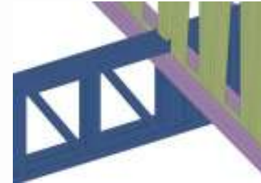
UNION CERCHA D CON MURO FACHADA EJE 4
