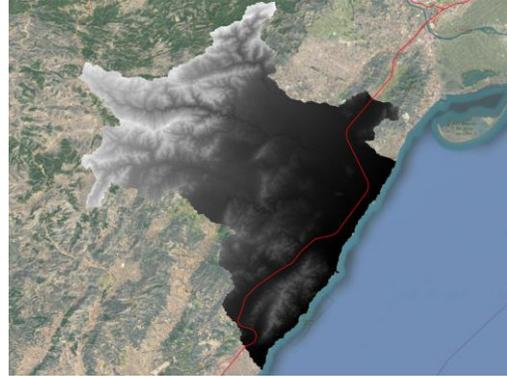
Generación de capas de rugosidad, pendientes e infiltración asociadas al terreno (Corine Land Cover y IC 5.2).
