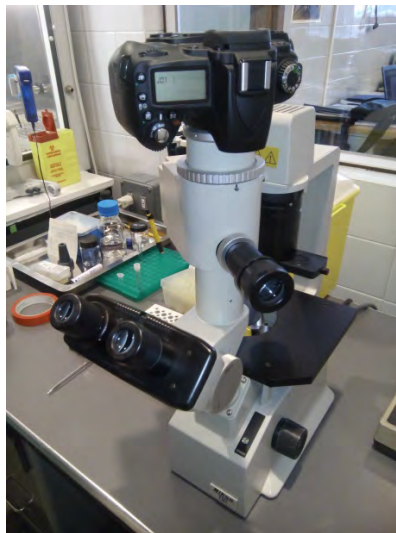
Figura 4.2: Microscopio óptico utilizado para la toma de imágenes.
