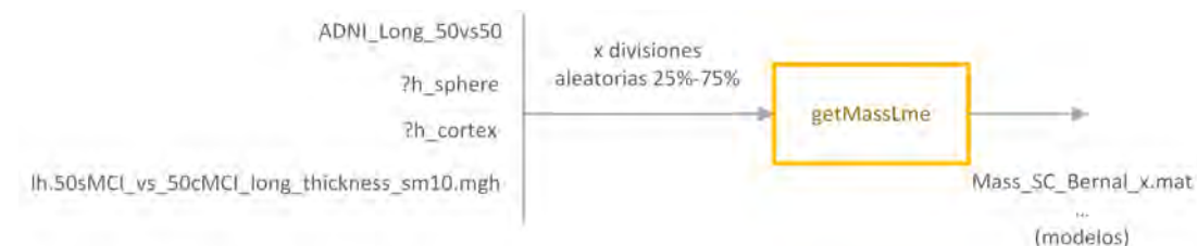
Figura 4.24: Esquema de los archivos de entrada y salida en el flujo de trabajo de buildMassLmeModels, donde se generan x modelos distintos basados en distintos subgrupos de sujetos.
