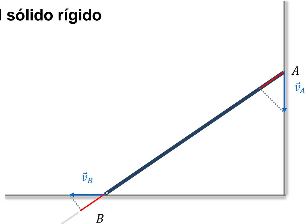
En este caso conocida  $\vec{v}_A$  ya podemos conocer  $\vec{v}_B$ , aplicando la condición de equiproyectividad. En general necesitaremos conocer la velocidad de tres puntos no alineados para determinar la velocidad de cualquier otro punto.
