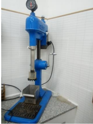
Foto 7. Celda de Flotación DENVER
