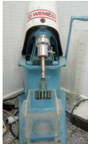
Foto 8. Celda de Flotación WEMCO
